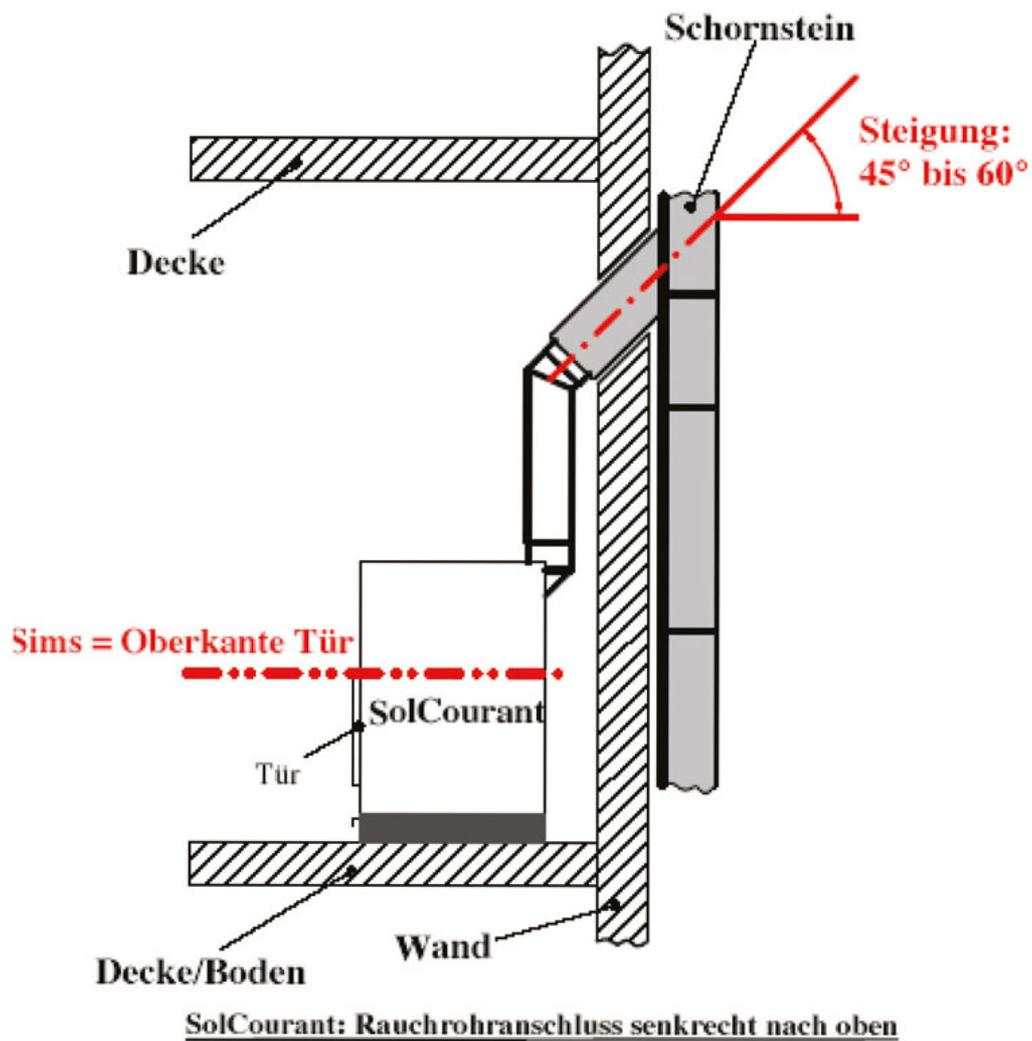
Das Rauchgasrohr sollte möglichst steigend verlegt werden.
